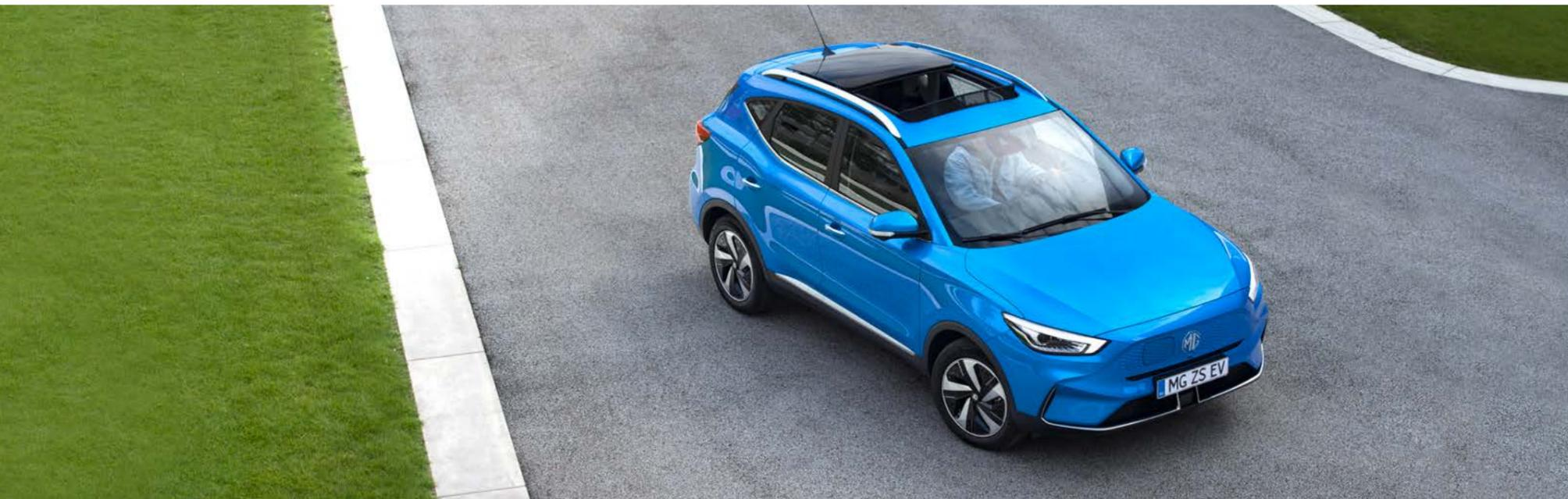
Le pack de batterie de 51 kWh offre une autonomie améliorée allant jusqu'à 320 km selon la norme WLTP. Le pack de batterie de 70 kWh, quant à lui, offre une autonomie étendue allant jusqu'à 440 km selon la norme WLTP. Grâce à la capacité de charge rapide allant jusqu'à 92 kW sur la batterie 70 kWh, les deux packs de batteries peuvent recharger la voiture de 5 % à 80 % en seulement 40 minutes.
