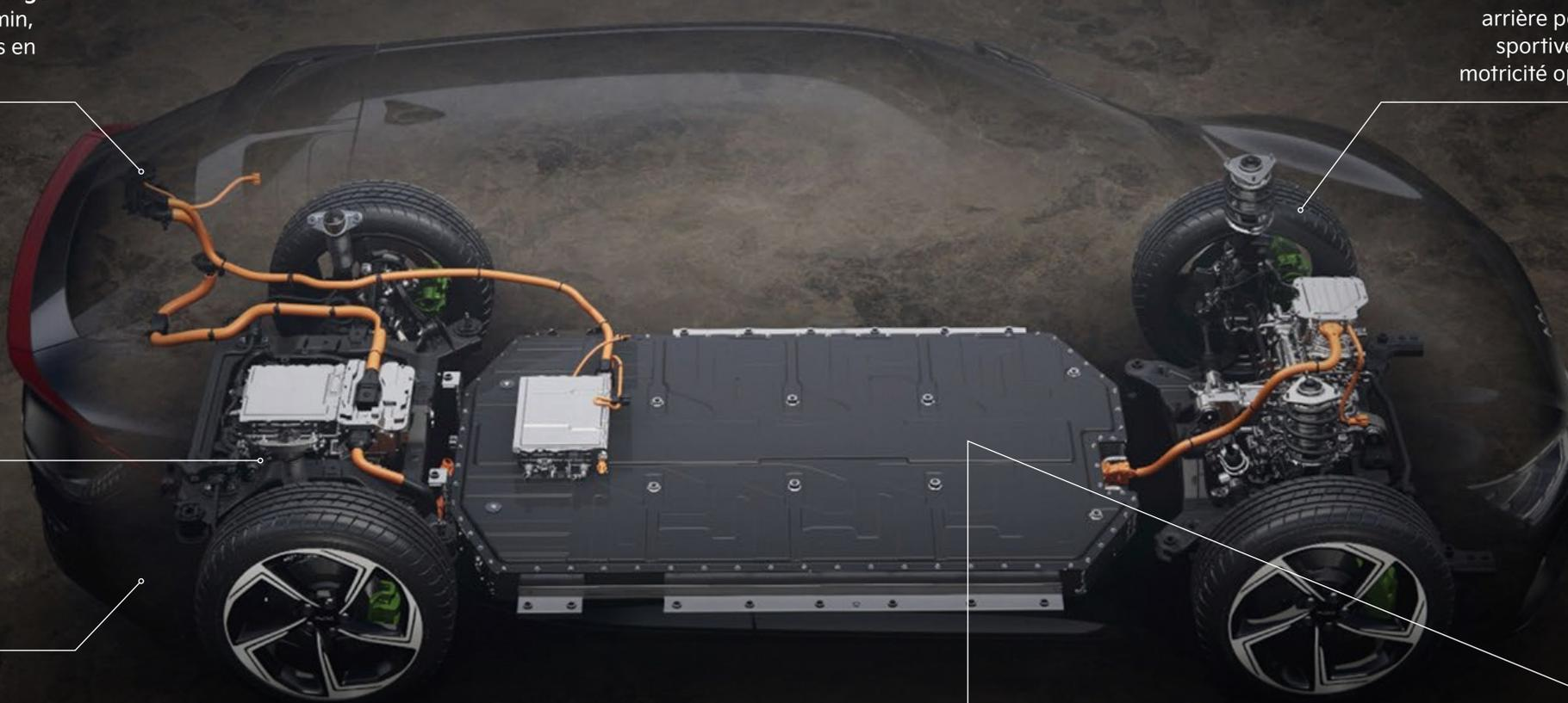
**Batterie de 77,4 kWh** Lithium-ion bénéficiant des dernières technologies pour une haute densité énergétique offrant une **autonomie jusqu'à plus de 510 km** (selon version).
