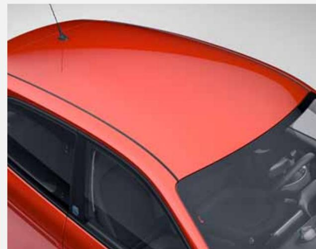
Toit composite peint dans le ton de la cellule de sécurité tridion
