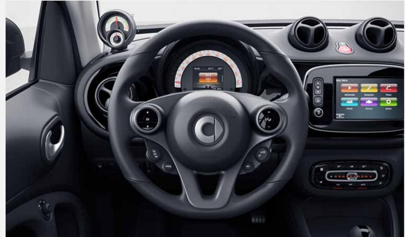
Volant multifonction à 3 branches en cuir et instrument complémentaire avec affichage de la puissance et du niveau de charge de la batterie
